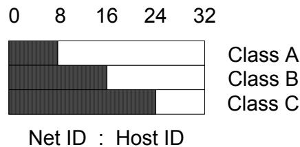
รูปที่ 1.1 รูปแสดงจำนวน Net ID และ Host ID ของ IP Address แบบ Class A, B และ C
